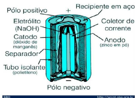
Figura 5. Estrutura de uma pilha
