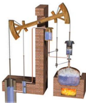
Máquina a vapor de Newcomen: Considerada a primeira máquina a vapor prática.
