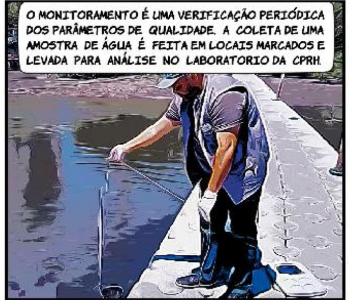
ALGUNS PARÂMETROS SÃO MEDIDOS NO PRÓPRIO LOCAL DE COLETA UTILIZANDO-SE SONDAS. SÃO AS CHAMADAS MEDIÇÕES DE CAMPO. AS SONDAS SÃO EQUIPAMENTOS COM ELETRODOS ESPECÍFICOS PARA VERIFICAÇÃO DE ALGUMAS VARIÁVEIS DE QUALIDADE.
