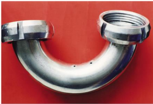
Corrosão por Pite
