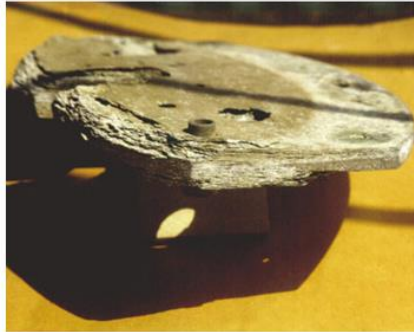
Corrosão por Esfoliação
